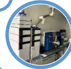
UHPLC-MS/MS Shimadzu / AB Sciex Qtrap 4500
